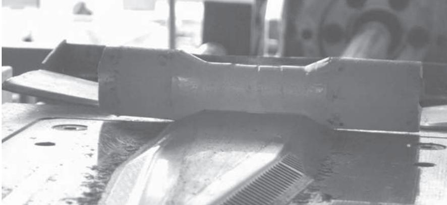
bereich in Verbindung mit einer definierten Erwärmung wird erstmals eine vollständige Prozesskette zur halbwarmen Herstellung von Langteilen in Betrieb genommen.
