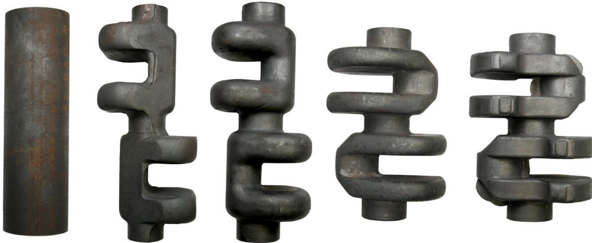
Bild 9: Stadienfolge einer gratlos geschmiedeten Kurbelwelle
