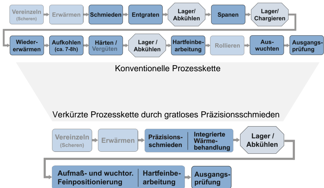
Bild 4: Verkürzung der Prozesskette durch gratloses Präzisionsschmieden nach Doege
