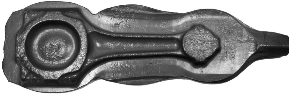
Bild 2: Bauteil mit Grat am Beispiel eines Pleuels (Langteil)
