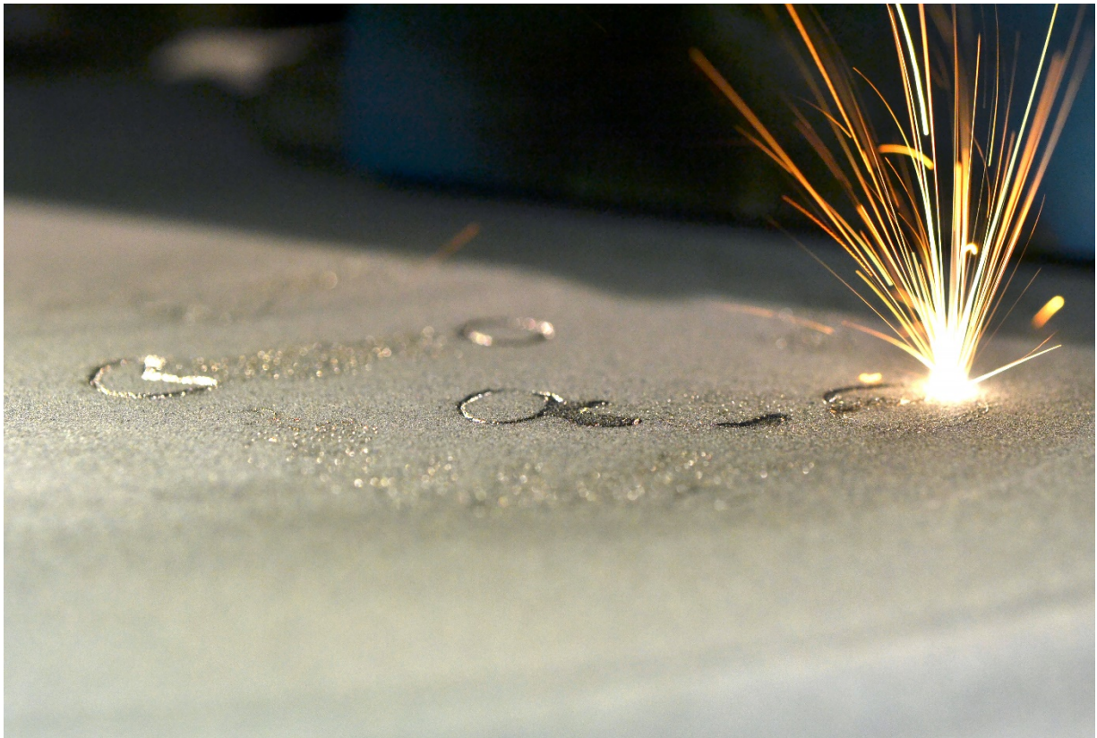
Bild 4: Additives Fertigungsverfahren Laser-Strahlschmelzen
