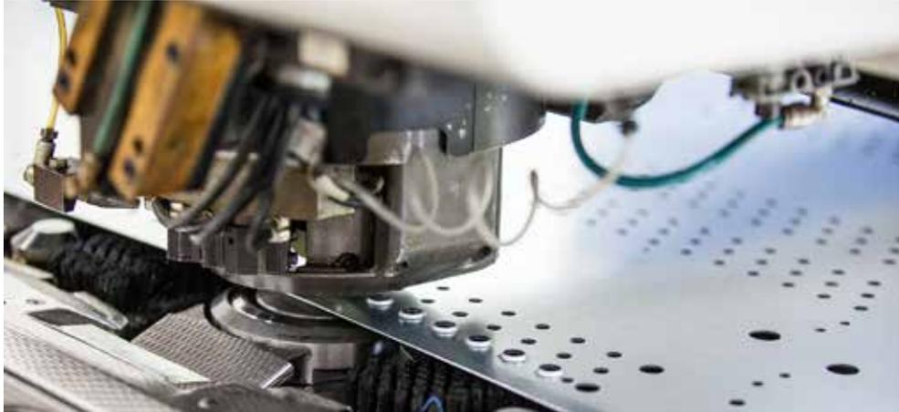
Unentdeckte Fehler sind meist besonders problematisch. Wird beispielsweise im ersten Bearbeitungsschritt ein etwas zu großes Loch ins Blech gestanzt, fällt zunächst vielleicht nicht auf, dass zu viel Material abgetragen wurde. Später kann das jedoch zum Problem werden, wenn bei einem der folgenden Prozessschritte unerwünschte Verformungen auftreten oder das Blech sogar reißt.
