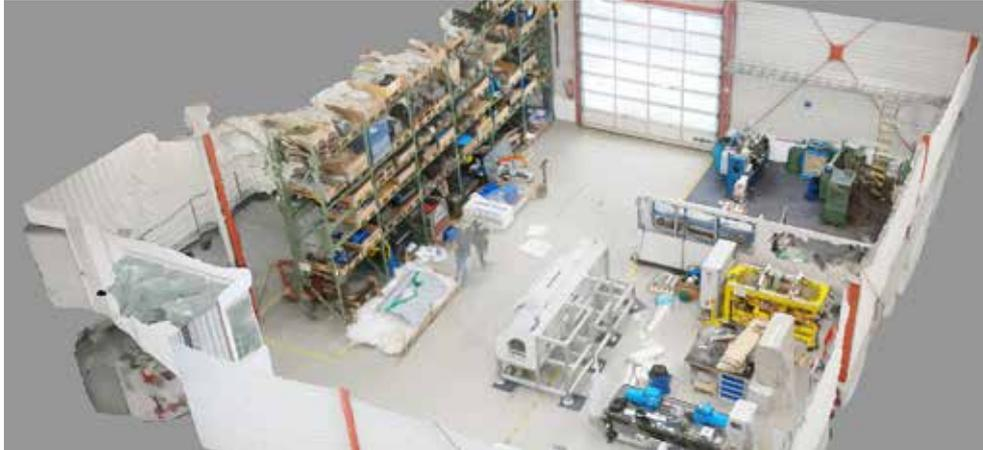
Das 3D-Layout, das auf diese Weise entsteht, lässt sich in einem CAD-Programm bearbeiten: Anlagen können an einen anderen Ort verschoben, Maschinen entfernt oder hinzugefügt werden. So lässt sich die Produktionshalle schnell und einfach umgestalten. Die Genauigkeit ist derzeit für Groblayouts ausreichend: Sämtliche Maße werden auf etwa 5 Zentimeter genau erfasst.
