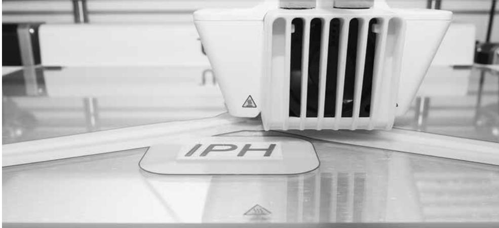
Zusätzlich hat das IPH weitere 3D-Drucker unterschiedlicher Größen, Preisklassen und Genauigkeiten angeschafft: Von einem relativ günstigen Modell bis zum präzisen Industriedrucker. Der Großteil dieser Drucker arbeitet nach dem Prinzip des "Fused Deposition Modeling" (FDM). Sie stellen Druckerzeugnisse her, indem sie geschmolzenen Kunststoff Schicht für Schicht auftragen. Ein weiterer Drucker nutzt Stereolithografie (SLA), dabei wird flüssiges Harz per Laser ausgehärtet.
