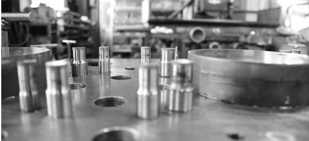
Für das untersuchte Werkzeug haben die IPH-Ingenieure etwa zehn mögliche Konstruktionsfehler identifiziert, die für den Ausschuss verantwortlich sein könnten. Diese haben sie unter anderem mithilfe von FEM-Simulationen genauer betrachtet. Dabei bemerkten sie eine ungleichmäßige Spannungsverteilung bei einem von mehreren Vorformschritten. Die Ingenieure vermuteten, dass dadurch Verfestigungen im Blech entstehen, die später eine maßhaltige Umformung verhindern.
