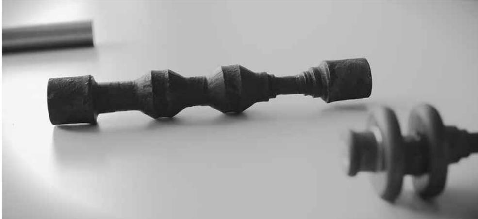
Insgesamt haben die Forscher 32 Prozess-Varianten experimentell untersucht. Das Ergebnis: Die mehrdirektionale Umformung querkeilgewalzter Vorformen kann gelingen, ohne dass Grat entsteht – wenn man die Parameter richtig wählt. So sollte eine Vorform mit flachem Schulterwinkel und geringer Querschnittsflächenreduktion gewählt werden. Zudem sollte das Bauteil bei niedriger Temperatur und geringer Geschwindigkeit mehrdirektional umgeformt werden, um Gratbildung zu verhindern.
