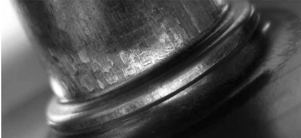
einen Flansch aus einem anderthalb Zentimeter starken Blech und einem zylindrischen Mittelstück.
