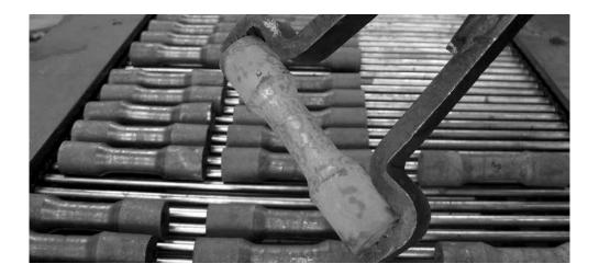
CoVaForm: Optimale Materialausnutzung dank Querkeilwalzen
