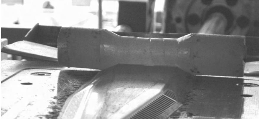
bereich in Verbindung mit einer definierten Erwärmung wird erstmals eine vollständige Prozesskette zur halbwarmen Herstellung von Langteilen in Betrieb genommen.
